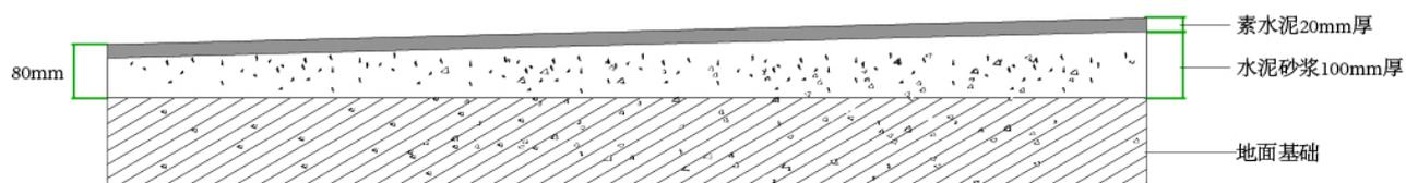
地面硬化剖面图（垃圾房前面80mm，后面硬化120mm）
