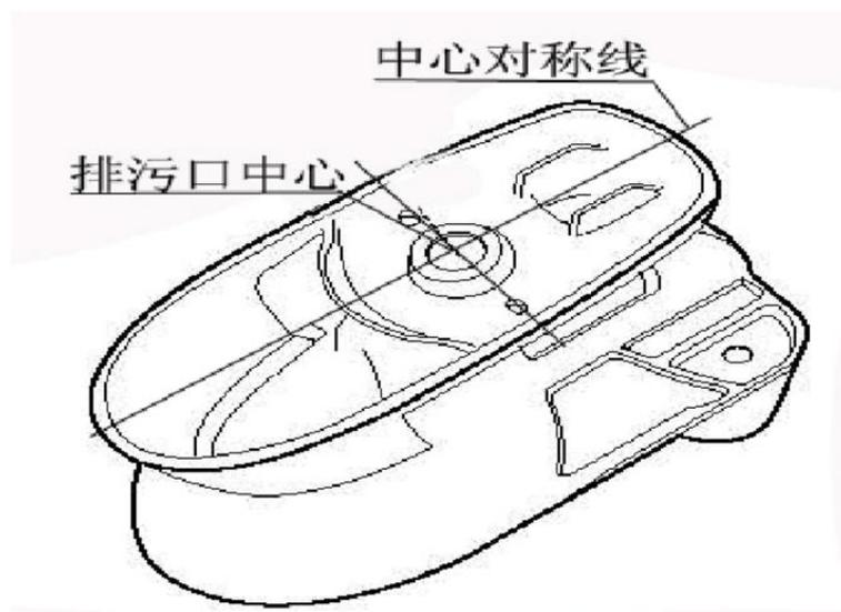
3、将座便器排水口与下水口对齐，使坐便器上的十字线与地面排污口的十字线对准吻合后，用铅笔沿座便器基座接触的地面的边沿画一圈座便器位置线后，将座便器移开。
